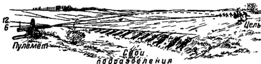
Рис. 37. Определение возможности ведения огня поверх своих подразделений отметкой прицела
