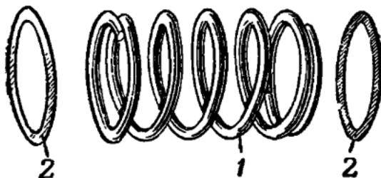
Рис. 48. Ствольная пружина:
