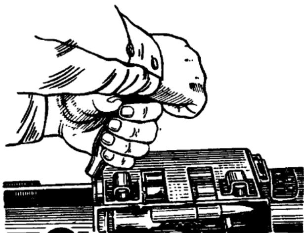
**Рис. 99. Извлечение патрона из ленты при разряжании пулемета**
