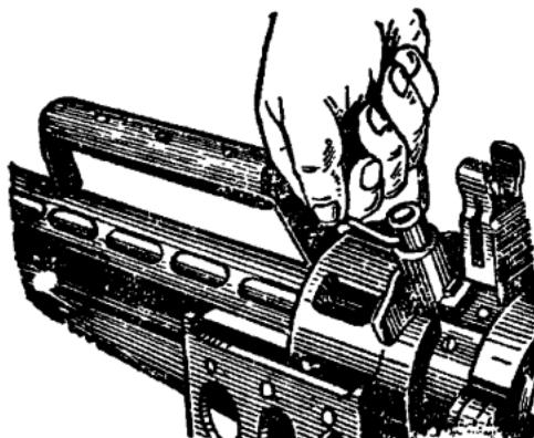
Рис. 5. Поворот соединительной муфты
