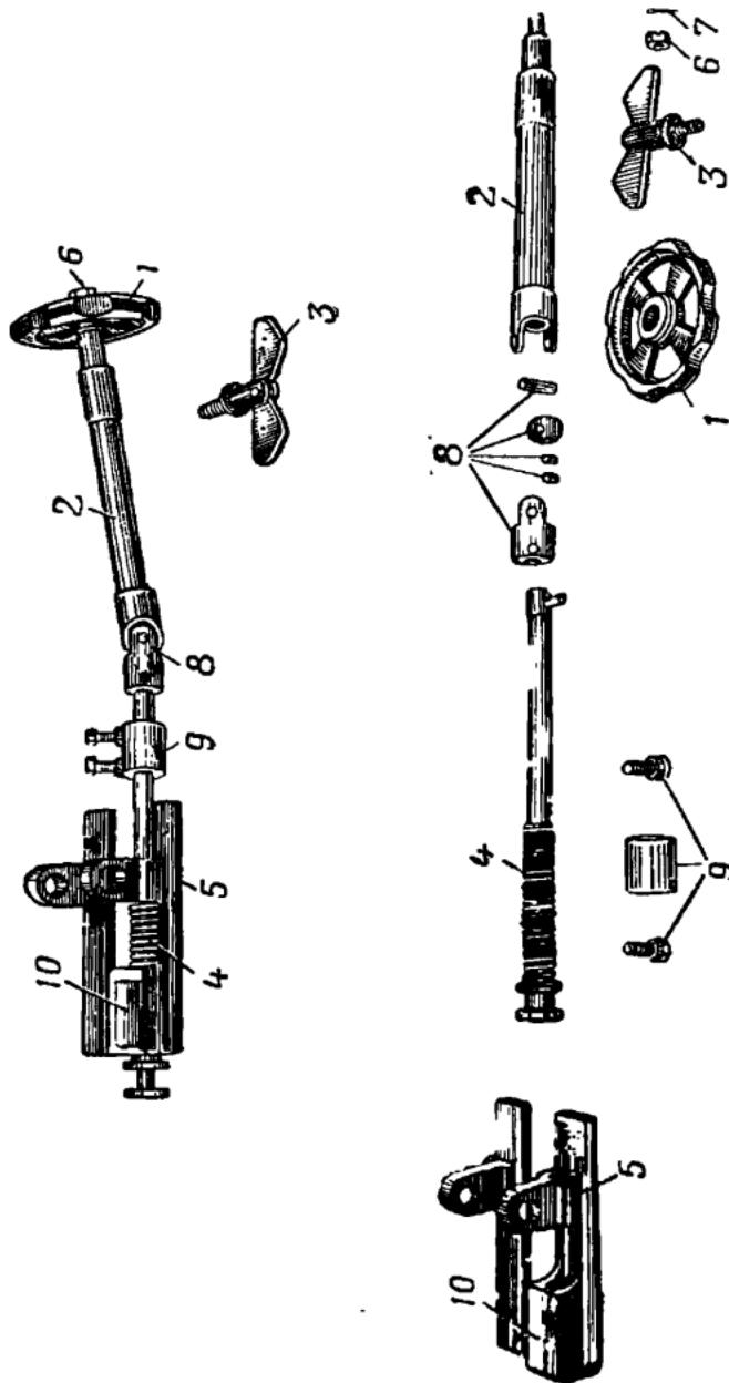
Рис. 80. Механизм тонкой вертикальной наводки (в собранном и разобранным виде):
