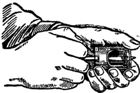
Рис. 39. Вывинчивание бойка из ударника
