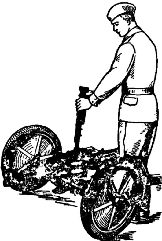
Рис. 7. Отделение крышки от ствольной коробки
