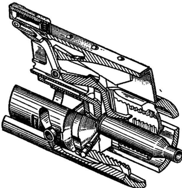
Рис. 98. Отражение последней гильзы
