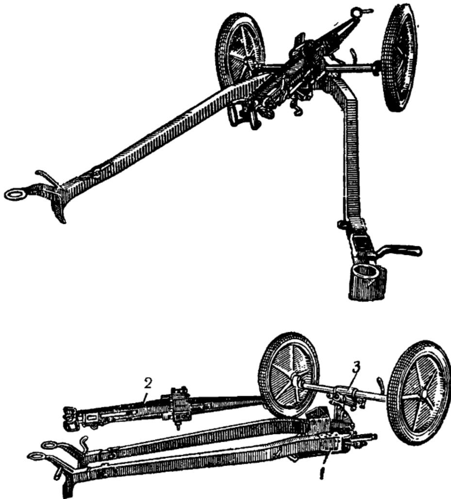
Рис. 3. Станок (в собранном и разобранном виде):
