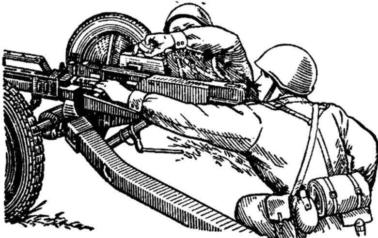
Рис. 112. Вставление ленты с наконечником в приемник
