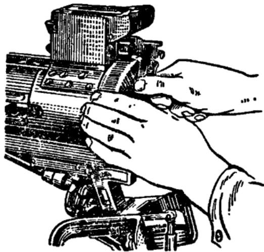
Рис. 11. Отделение затыльника от ствольной коробки
