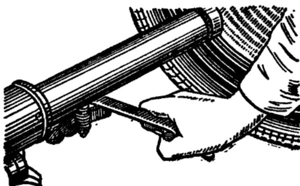
Рис. 30. Откидывание наметки крепления засова тяги станины
