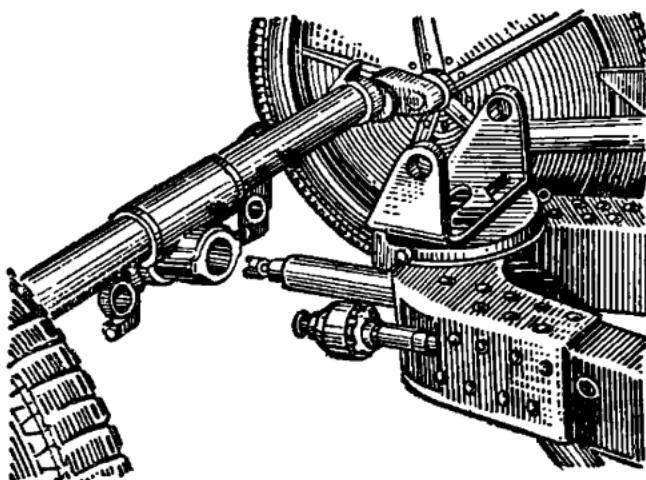
Рис. 33. Соединение хода с основанием стаика при поднятой боевой оси
