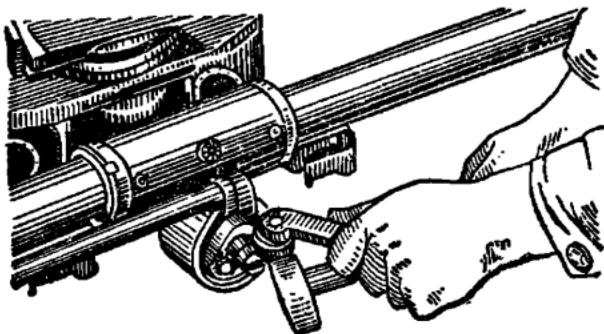
Рис. 29. Откidyвание наметки крепления хода станка
