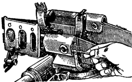
Рис. 26. Вывинчивание стопорного винта цапфы люльки
