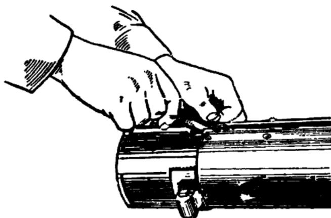
Рис. 38. Отделение рукоятки перезаряжания от ствольной коробки
