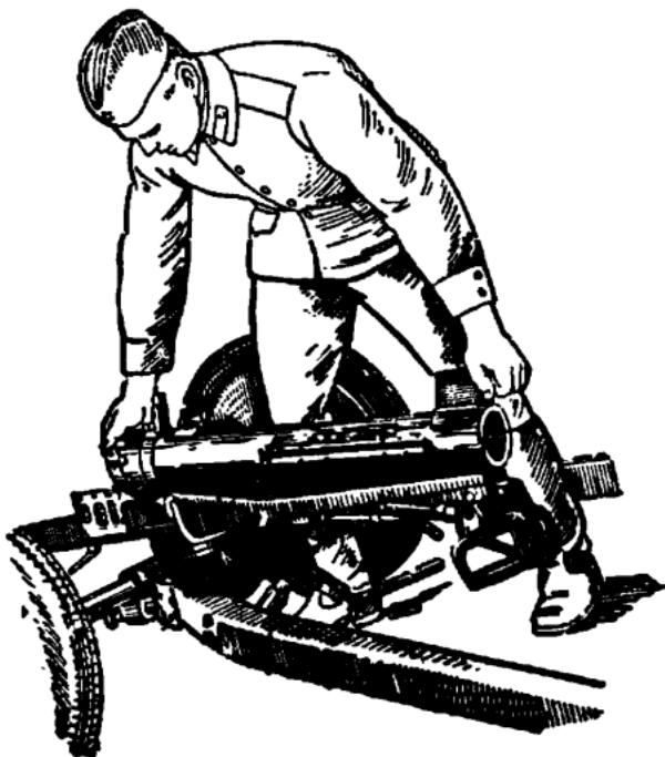
Рис. 16. Отделение ствольной коробки
