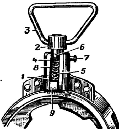
Рис. 51. Стопор соединительной муфты:
