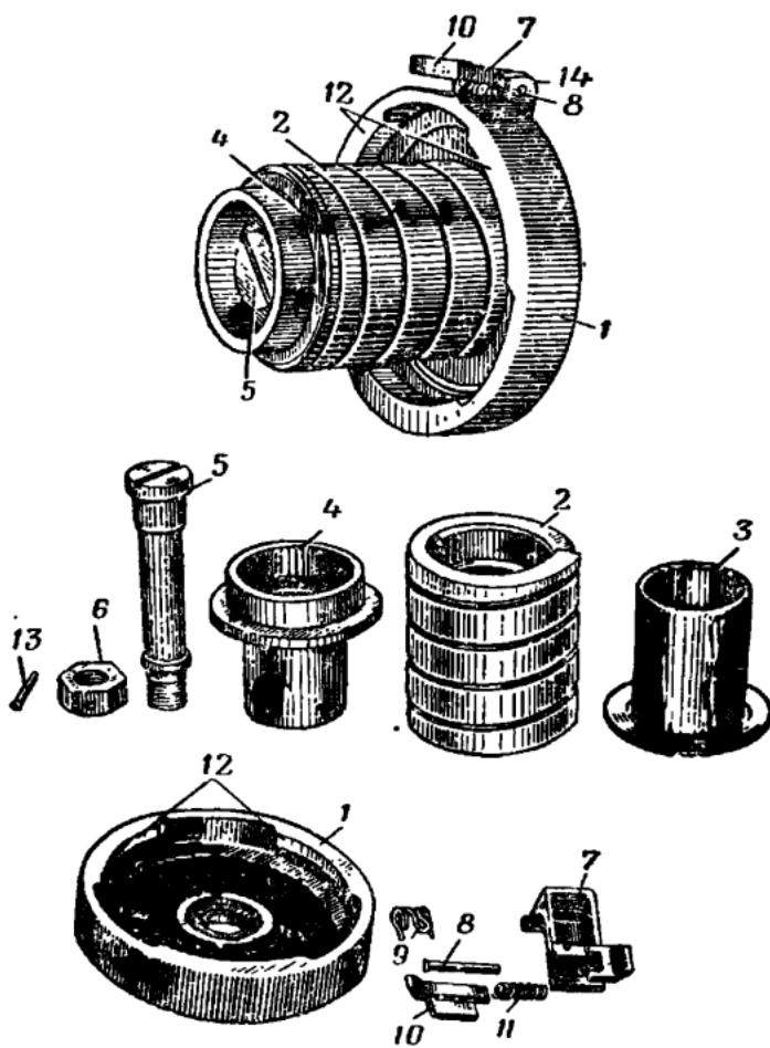
Рис. 68. Затыльник (в собранном и разобранном виде):
