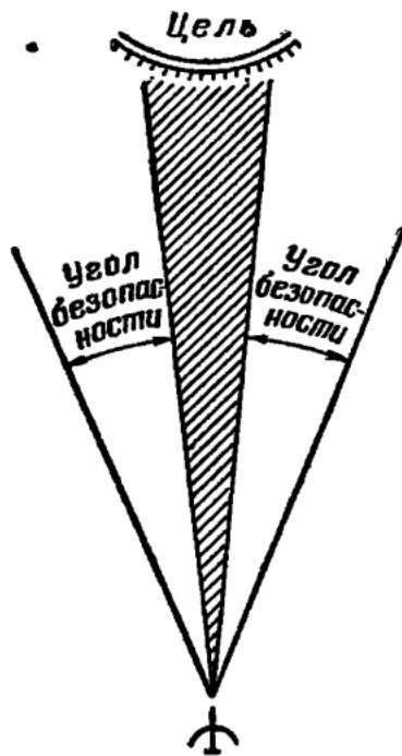
Рис. 117. Угол безопасности при стрельбе в промежутки и из-за фланга своих подразделений
