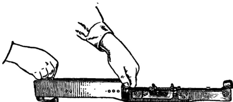
Рис. 22. Перемещение движка подачи в заднее положение
