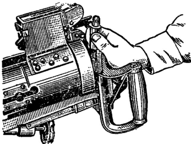
Рис. 9. Разъединение спусковой тяги
