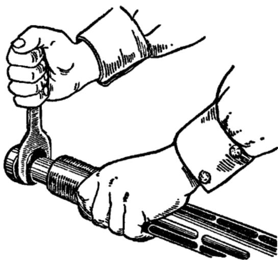
Рис. 35. Отвинчивание поршня от ствола
