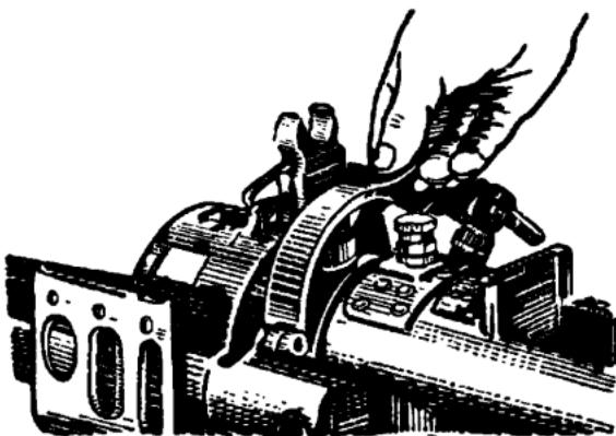
Рис. 15. Откidyвание наметки хомута крепления ствольной коробки
