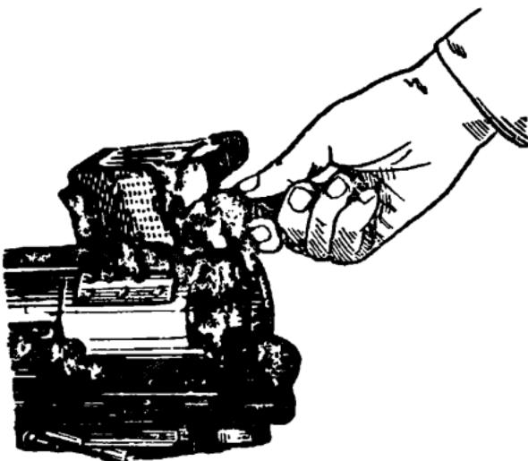
Рис. 12. Отделение спускового механизма от ствольной коробки
