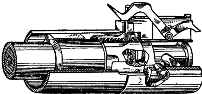
Рис. 96. Положение частей и механизмов пулемета после выстрела
