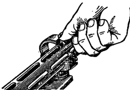
Рис. 4. Откидывание наметки хомута переднего крепления пулемета
