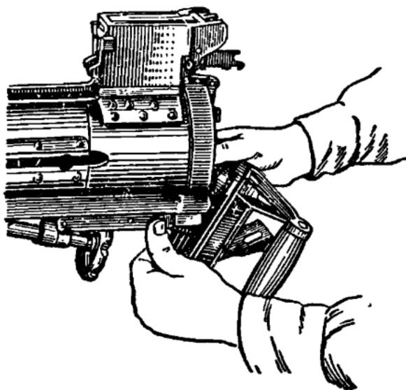
Рис. 10. Откидывание затыльника люльки вниз
