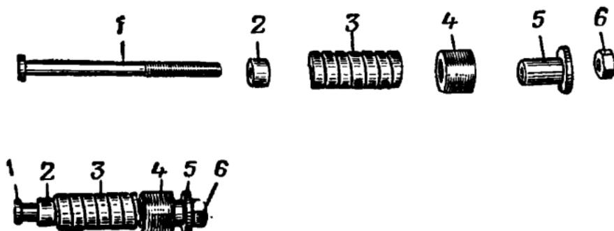
Рис. 78. Амортизатор (в собранном и разобранном виде):
