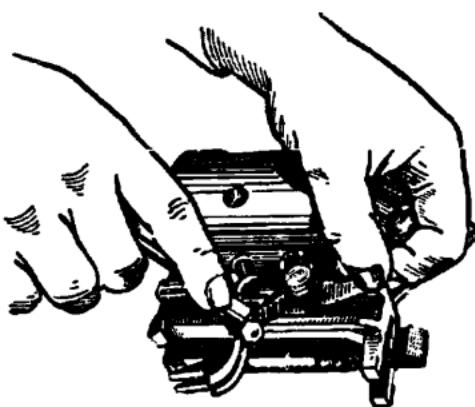
Рис. 37. Отделение разобщителя от остова затвора
