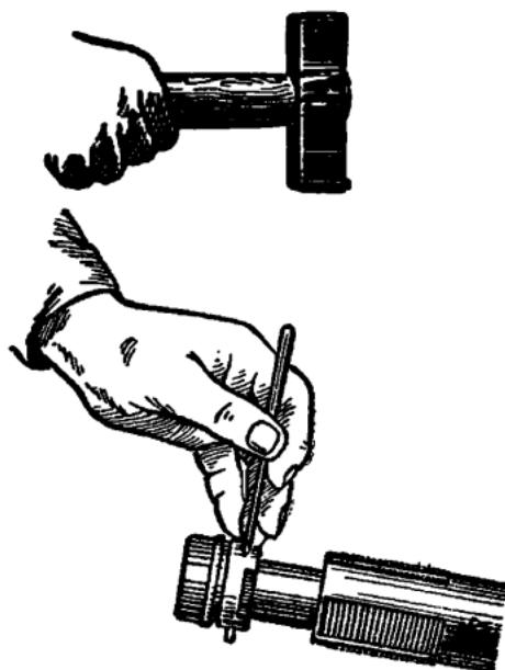
Рис. 34. Выталкивание штифта поршня
