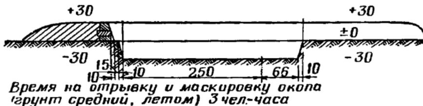
Рис. 120. Окоп для стрельбы лежа из 14,5-мм пехотного пулемета ПКП
