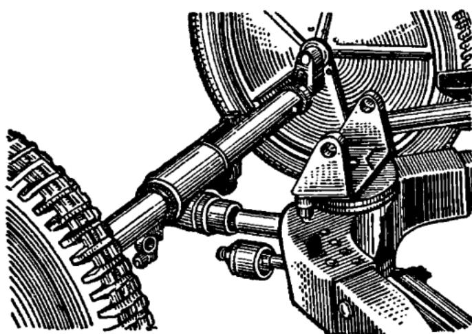
Рис. 32. Соединение хода с основанием стаика при опущенной боевой оси
