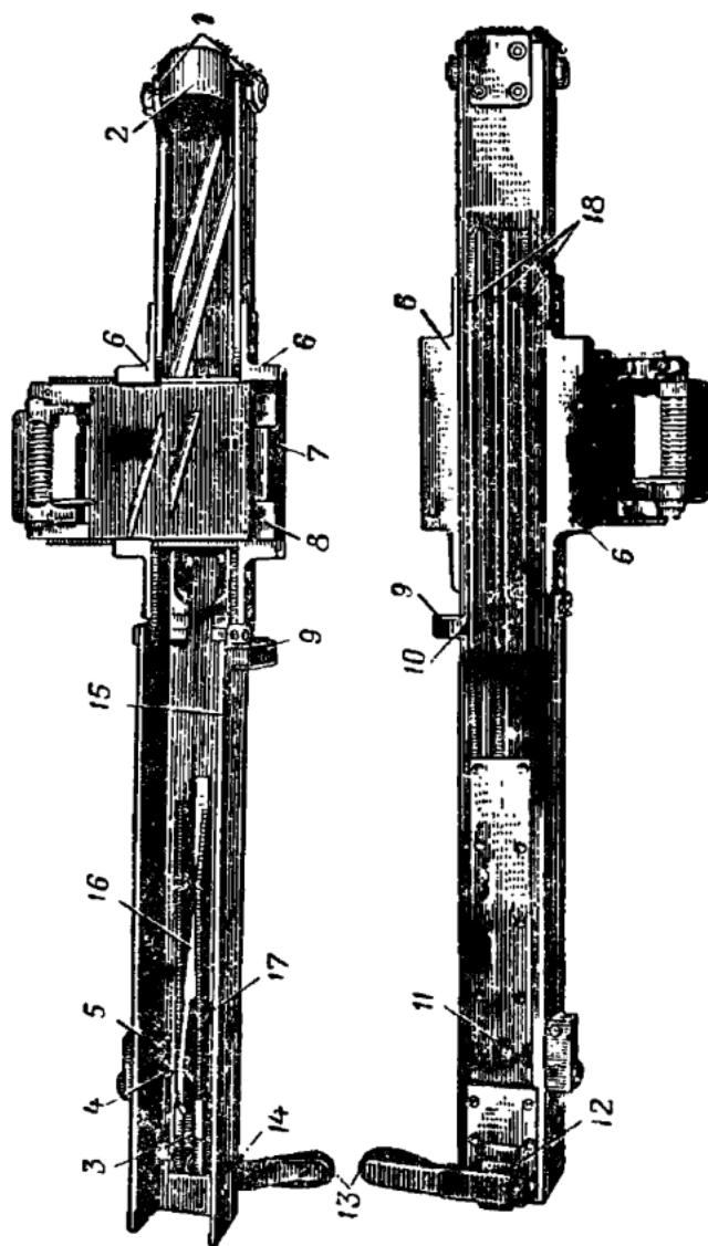
Рис. 63. Крышка ствольной коробки (вид сперу и сверху):
