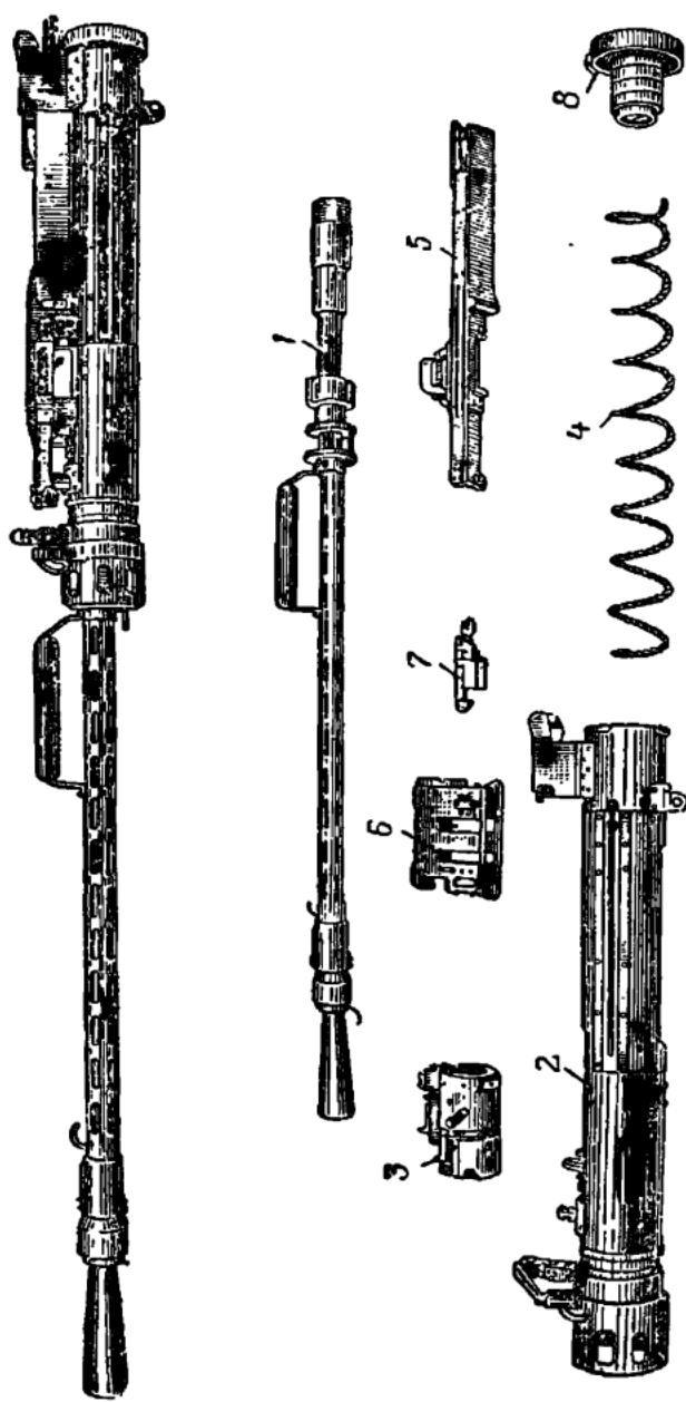
Рис. 2. Тело пулемета (в собранном и разобранном виде):
